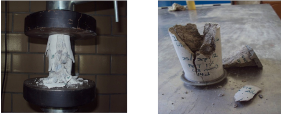
Figura 7. Prueba de resistencia a la compresión
